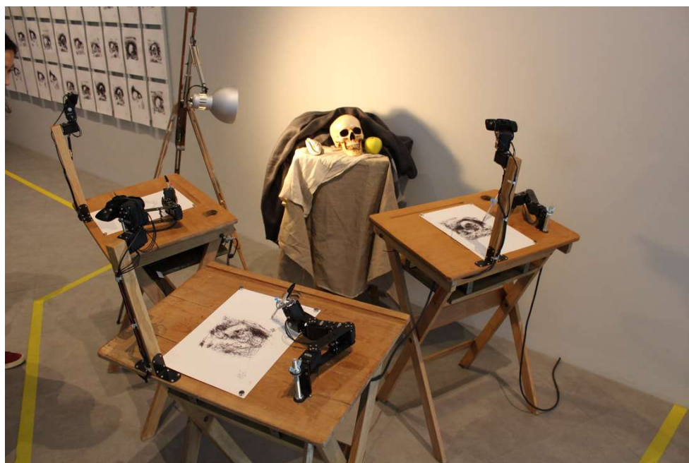
A oto kamery rejestrujące obraz i przetwarzające go tak, by mechaniczne dłonie mogły go nakreślić na papierze.
